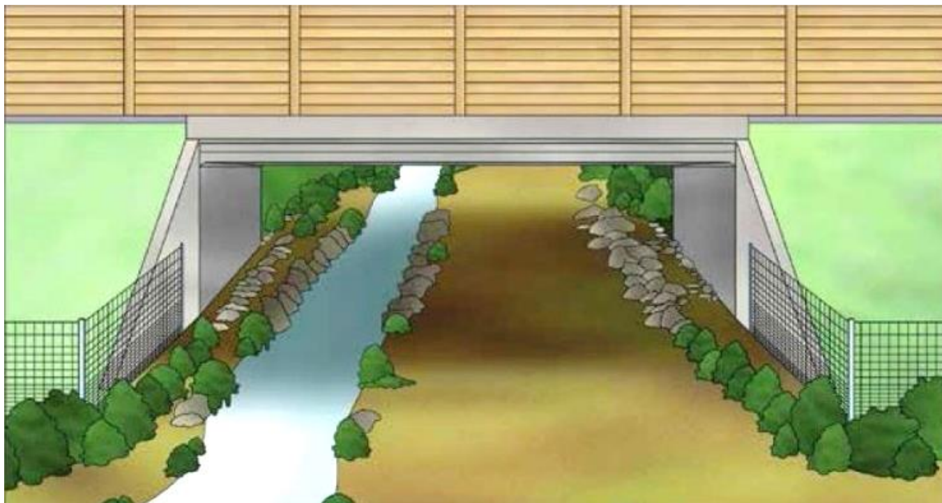
Obrázok 15: Príklad prevedenia a usporiadania prvkov v migračnom objekte väčšieho rámového priepustu
