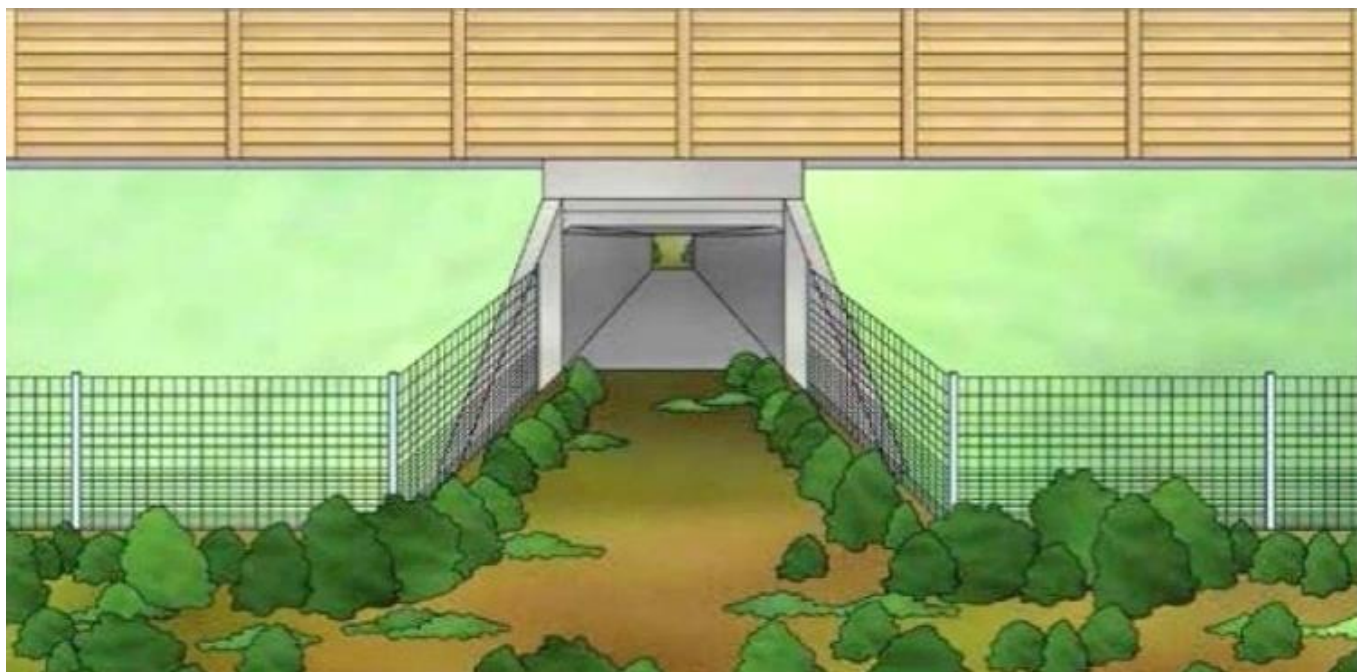
Obrázok 16: Príklad prevedenia a usporiadania prvkov v migračnom objekte menšieho rámového priepustu
